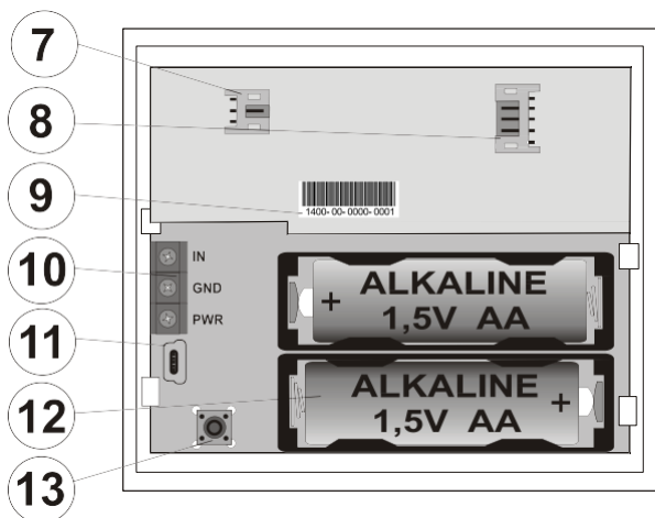
Rysunek 2: 7 – łącznik modułu audio; 8 – łącznik pierwszego segmentu sterowania; 9 – kod produktu; 10 – złącza; 11 – wejście mini USB; 12 – baterie; 13 – styk sabotażowy
